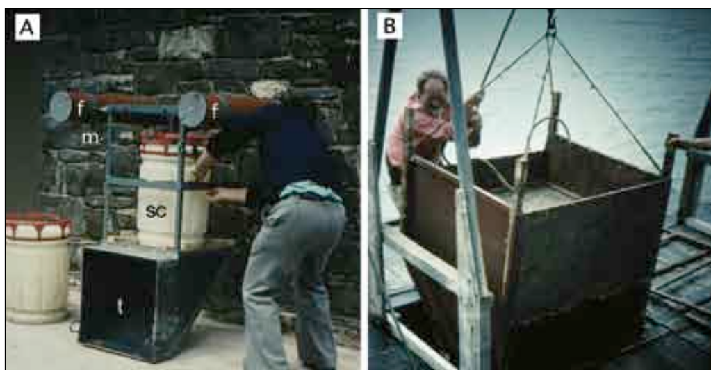
图108: 潮汐供电漂流式上升流系统——FLUPSYS。
